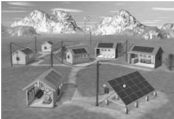
Abb. 2: Erweiterungsmöglichkeiten eines AC-gekoppelten Hybridsystems für eine Dorfstromversorgung
